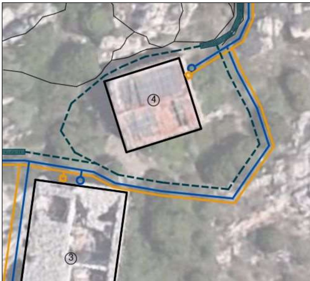
Fig. 12 – La linea tratteggiata blu indica l'area di cantiere attorno all'edificio 4
